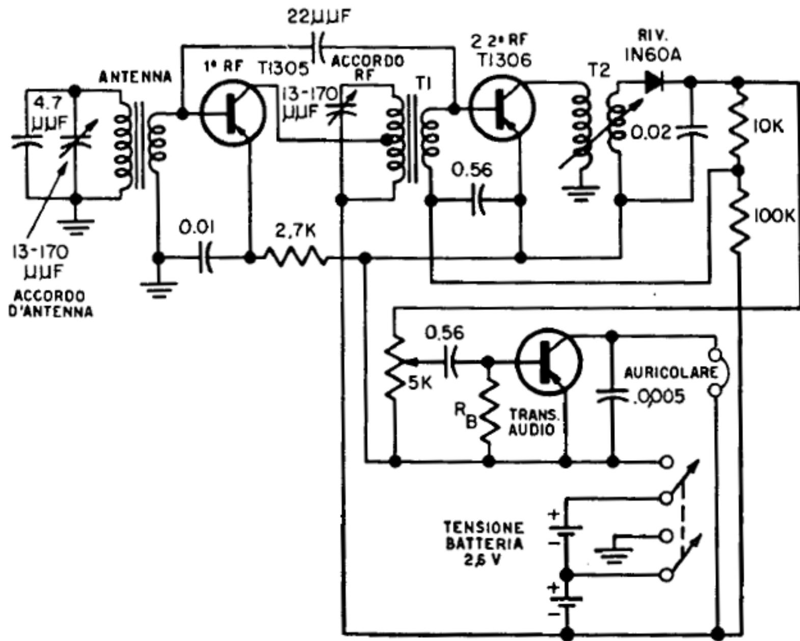
**Radoricevitore portatile per onde medie a tre transistori e ad accordo diretto Philco modello T-3.**
